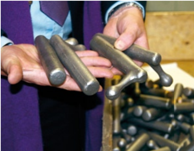
Einteilige Kammerrohlinge vor der Weiterbearbeitung
