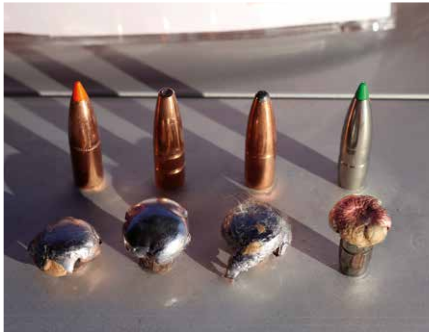
Umso mehr das Geschoss aufpilzt desto größer ist in der Regel der Ausschuss und umso mehr Schusszeichen wird man finden können.
