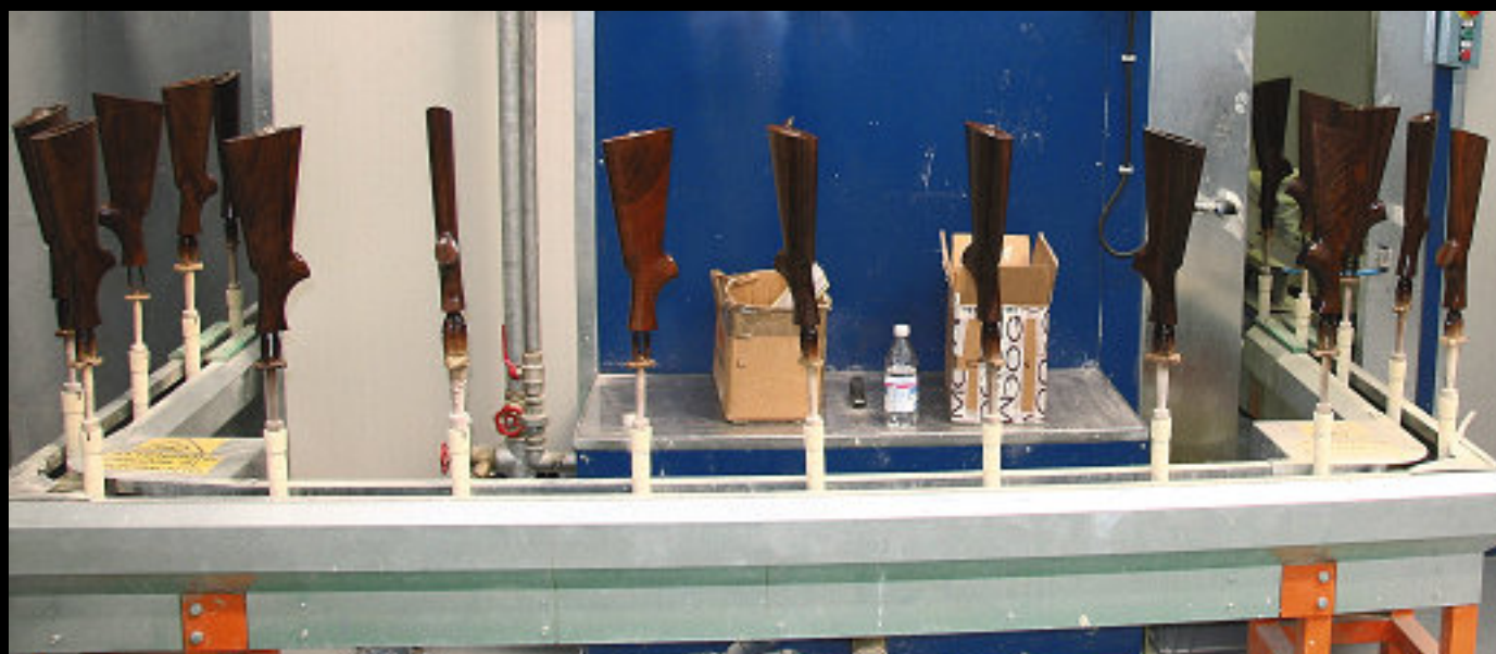
Vollautomatisch: In Reih und Glied laufen die Schaffthölzer über ein Förderband durch die Lackierungsanlage.
