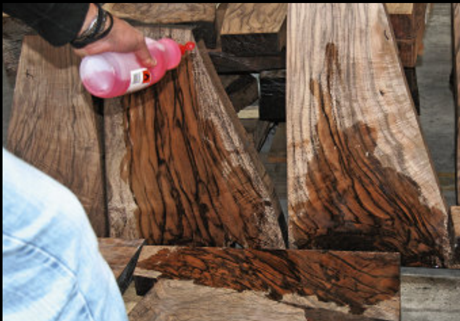
Mit einer Sprühflasche wird Alkohol auf das Holz aufgetragen, um die Maserung zu verdeutlichen.
